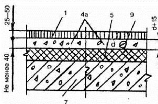
1а - верхний слой покрытия из мозаичного бетона (терраццо);
