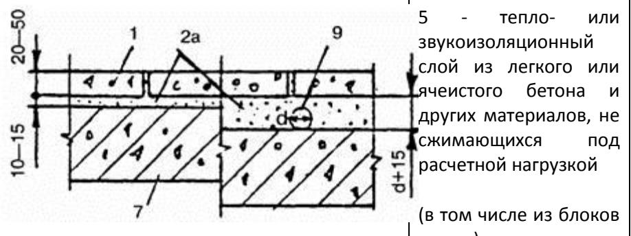
5 - тепло- или звукоизоляционный слой из легкого или ячеистого бетона и других материалов, не сжимающихся под расчетной нагрузкой (в том числе из блоков и плит);
