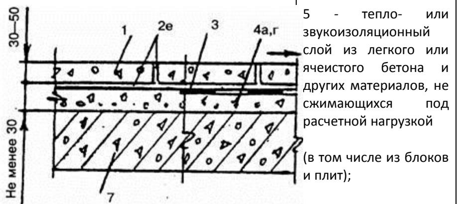
5 - тепло- или звукоизоляционный слой из легкого или ячеистого бетона и других материалов, не сжимающихся под расчетной нагрузкой (в том числе из блоков и плит);
