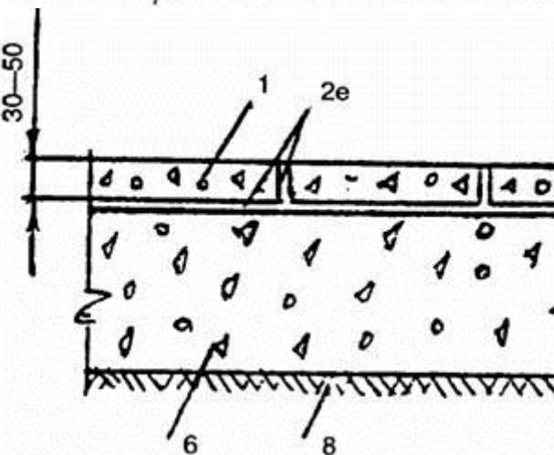
1 - покрытие из плит асфальтобетонных;
