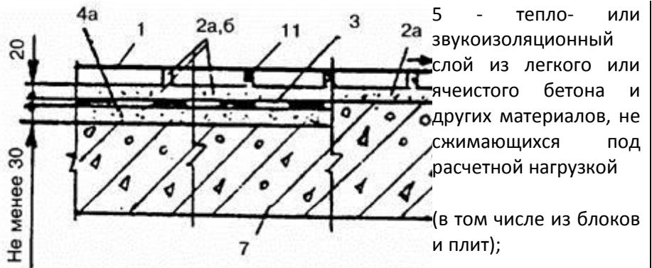
5 - тепло- или звукоизоляционный слой из легкого или ячеистого бетона и других материалов, не сжимающихся под расчетной нагрузкой (в том числе из блоков и плит);
