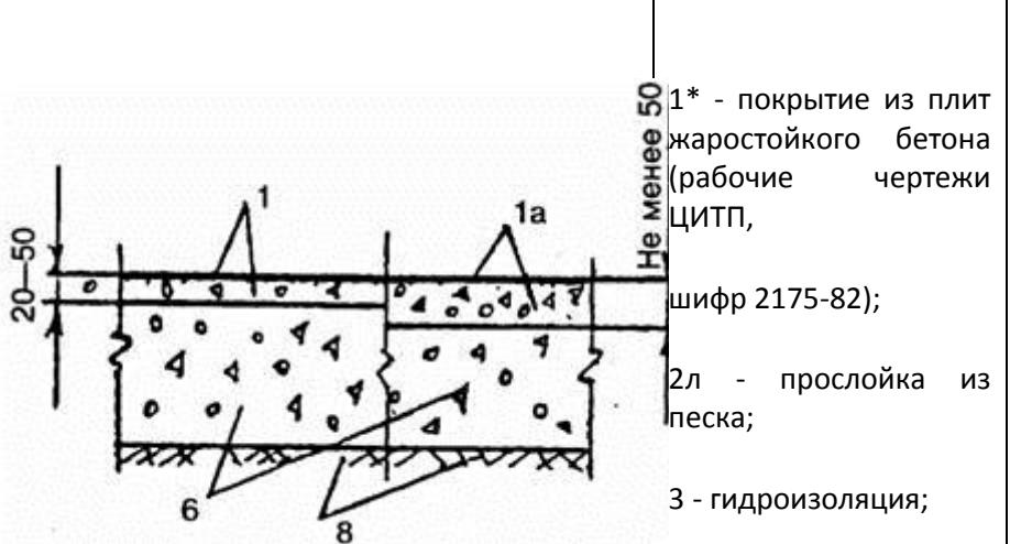
1\* - покрытие из плит жаростойкого бетона (рабочие чертежи ЦИТП, шифр 2175-82);
