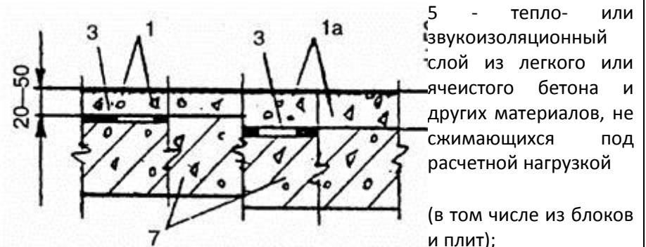
5 - тепло- или звукоизоляционный слой из легкого или ячеистого бетона и других материалов, не сжимающихся под расчетной нагрузкой (в том числе из блоков и плит);
