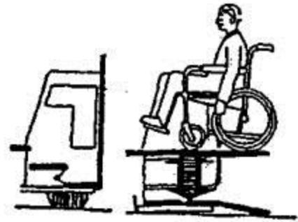
С помощью гидравлического подъемника
