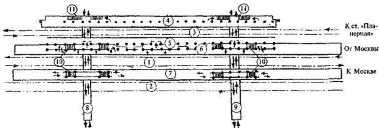
1, 2 — пути железнодорожной станции; 3 — пути метрополитена; 4, 5 — платформы метрополитена; 6, 7 — платформы железнодорожной станции; 8, 9 — подземные переходы, соединяющие платформы с выходом в город; 10 — лестницы, оборудованные пандусом или подъемником; 11 — лестницы, оборудованные эскалатором или подъемником
